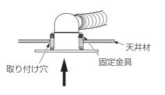
③吹き出し方向表示を確認し、グリルを正しい向きに合わせたあと、ねじを締めてグリルを天井材に固定する。
