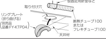
②①で入れたリングプレートを気密 シートの上から取り付け穴にはめ 込む。
