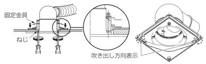
■電動ドライバーで使用時でも最後の締め付けは、手回しドライバーを 使用してください。天井材および製品の破損の原因になります。
