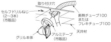
②固定金具を仮止めしているテープ をはずし、取り付け穴に差し込む。
