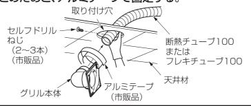
④固定金具を仮止めしているテープ をはずし、取り付け穴に差し込む。
